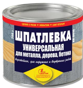
Шпатлевка ХВ-0016 отличается абсолютной водостойкостью покрытия и высокой адгезией к черным металлам. Может использоваться как для наружных, так и для внутренних работ. При нанесении тонким слоем шпатлевка быстро сохнет. Хорошо шлифуется, не растрескивается, устойчива к воздействию масла и бензина.
